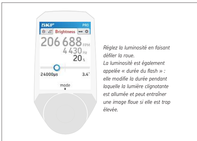
Fig. 17 – Luminosité / Durée du flash
