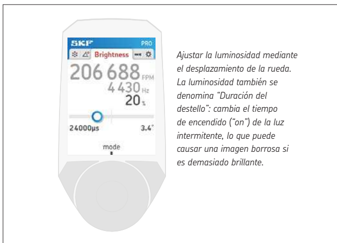
Fig. 17: Luminosidad/duración del destello
