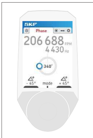
Abb. 13 – Phasenverschiebung mit TKRS 21
